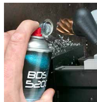
Schritt 2: Während des Bohrens Hochleistungs-fettspray auf die Bohrspitze und in die Bohrung sprühen.
