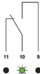
Leckstar 101 unter Spannung Leitungsbruch
