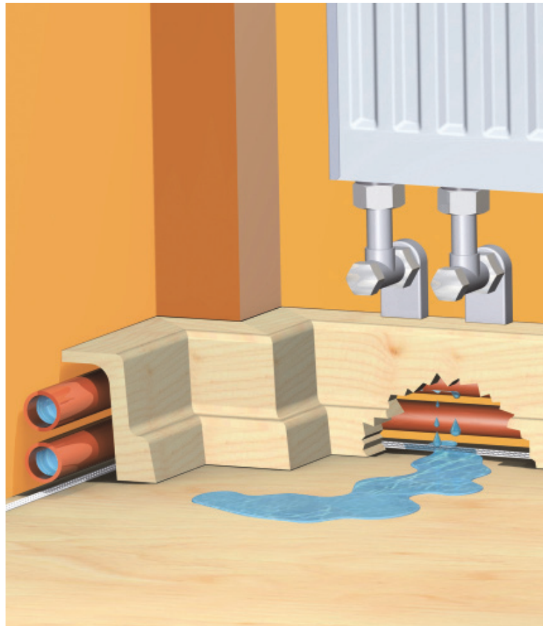
Einsatz einer Zwillingselektrode zur Detektion des Austretens von leitfähigem Heizungswasser unter einer rohrleitungsführenden Fußleiste
