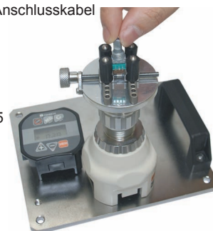
ATGE-G mit Tischbefestigung und Messstand
